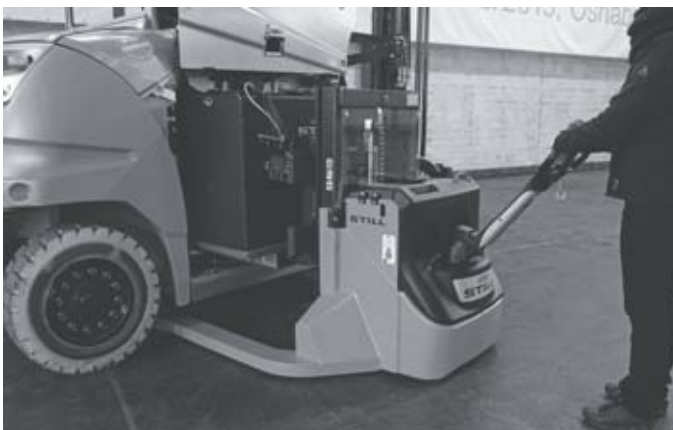
Cambio veloce della batteria con il sollevatore elettrico ECU 30
