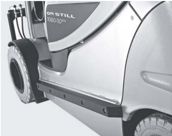
Protezione laterale per impieghi particolarmente gravosi
