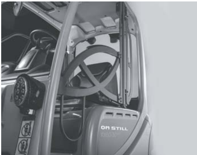
Sistema di ritenuta del conducente IWS
