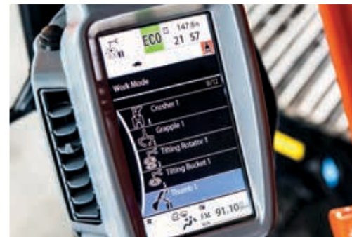
Due modalità di inclinazione e rotazione benna aumentano la versatilità del modello ZX190LC-6.
