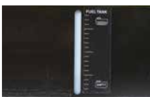
Indicatore visivo livello carburante
