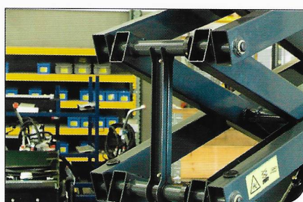
Staffa di sicurezza per le fasi di manutenzione
